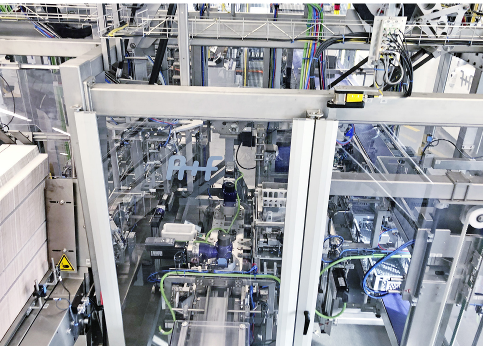
Der Sammelpacker setzt die Tiefziehschalen in Wrap-Around-Kartons (links) und in zwei Kunststoff-Mehrweggebinde (rechts) ein. Fotos: A+F
