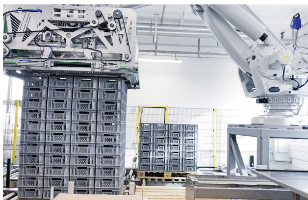
Bei den Mehrweggebinden übernimmt der Roboter-Palettierer auch deren Zuführung zum Packer.
