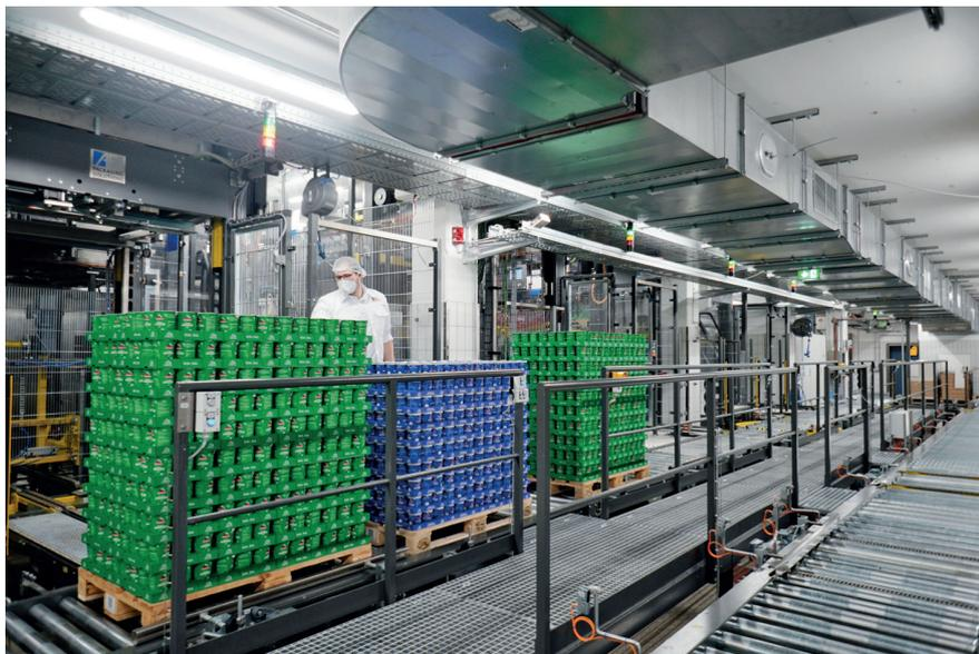
Zu Beginn verfügte das Palettierzentrum über drei Becher-, eine Eimer- sowie eine Milchverbundkartonanlage. In Folgeprojekten wurden ein Glaspalettierer integriert und die Kartonanlage zu einem Hochleistungs-Becherpalettierer umgerüstet. Fotos: A+F Automaiton
