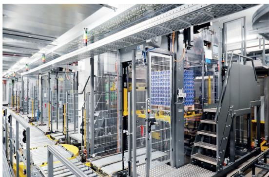
Alle Palettierer arbeiten nach dem Prinzip der heben- und absetzen der Palette. Das bedeutet, dass eine Leerpallette eingefahren und dann auf das jeweilige Palettierniveau gefördert wird.
